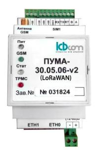
Контроллер «PUMA30.05.06-LoraWAN» предназначен для построения автоматизированных информационно-измерительных систем коммерческого учёта электроэнергии (АИИС КУЭ) и других энергоресурсов, а также для построения систем мониторинга, диспетчеризации, контроля состояния и управления режимами оборудования удаленного объекта.
